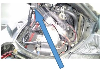
コントロールユニット本体取付位置は付属のボルトセットにて取り付けしてください。
