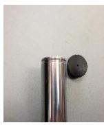
年式・形式等によりフォークの脱落防止の為、インナーチューブ上部に固定している車両もあります、まず小さいドライバー等により取り外してください。
