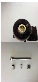
フォークの取り外しが出来ましたら、キャップボルトを外しフォークスプリングを取り外す作業、下のドレンボルトを外して中のオイルを抜いて下さい。
