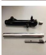
次に新しいインナーチューブにダンパーロッド・バネ（方向無し）を組み付けてインナーチューブに挿入します。
