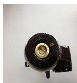
まず最初にフォークを取り外す前に、アウターチューブ下のドレンボルトを緩めておくと後の作業が大変スムーズに行えます。
